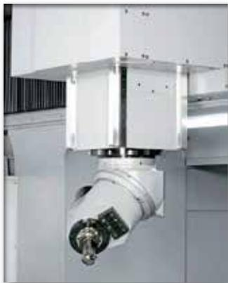
Sono disponibili in opzione le seguenti teste con bloccaggio idraulico:
