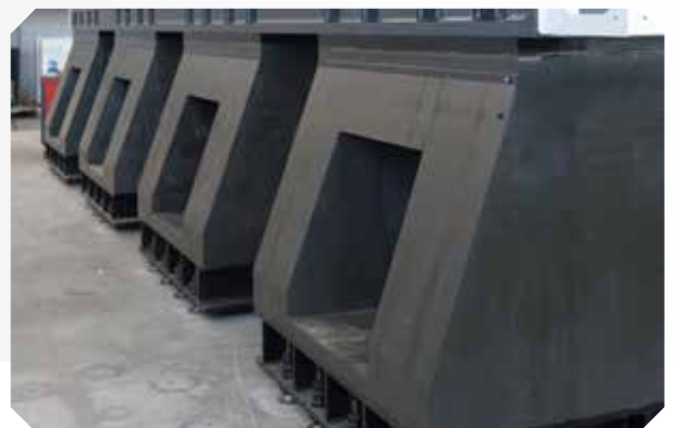
Seitenständer aus Polymerbeton
