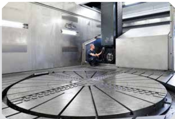
Tavola rotante per applicazioni di fresatura e di tornitura
