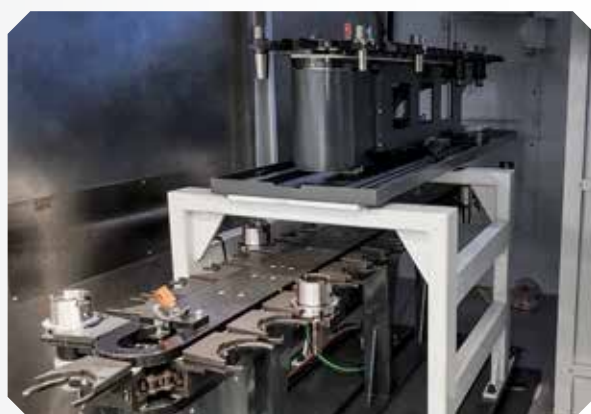
Cambio utensile a doppio magazzino
