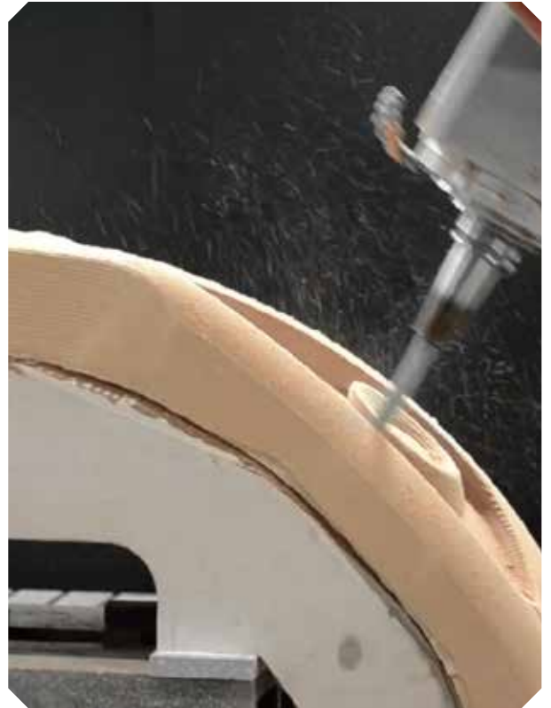
Lavorazione di un modello in resina
