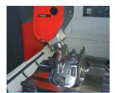
Die RTCP Funktion kann ebenso für 3-Achs Programme verwendet werden: Ausrichtung von Kopf oder Tisch muss manuelle gemacht werden, die Werkzeugspitze befindet sich in Kontakt mit dem Werkstück.
