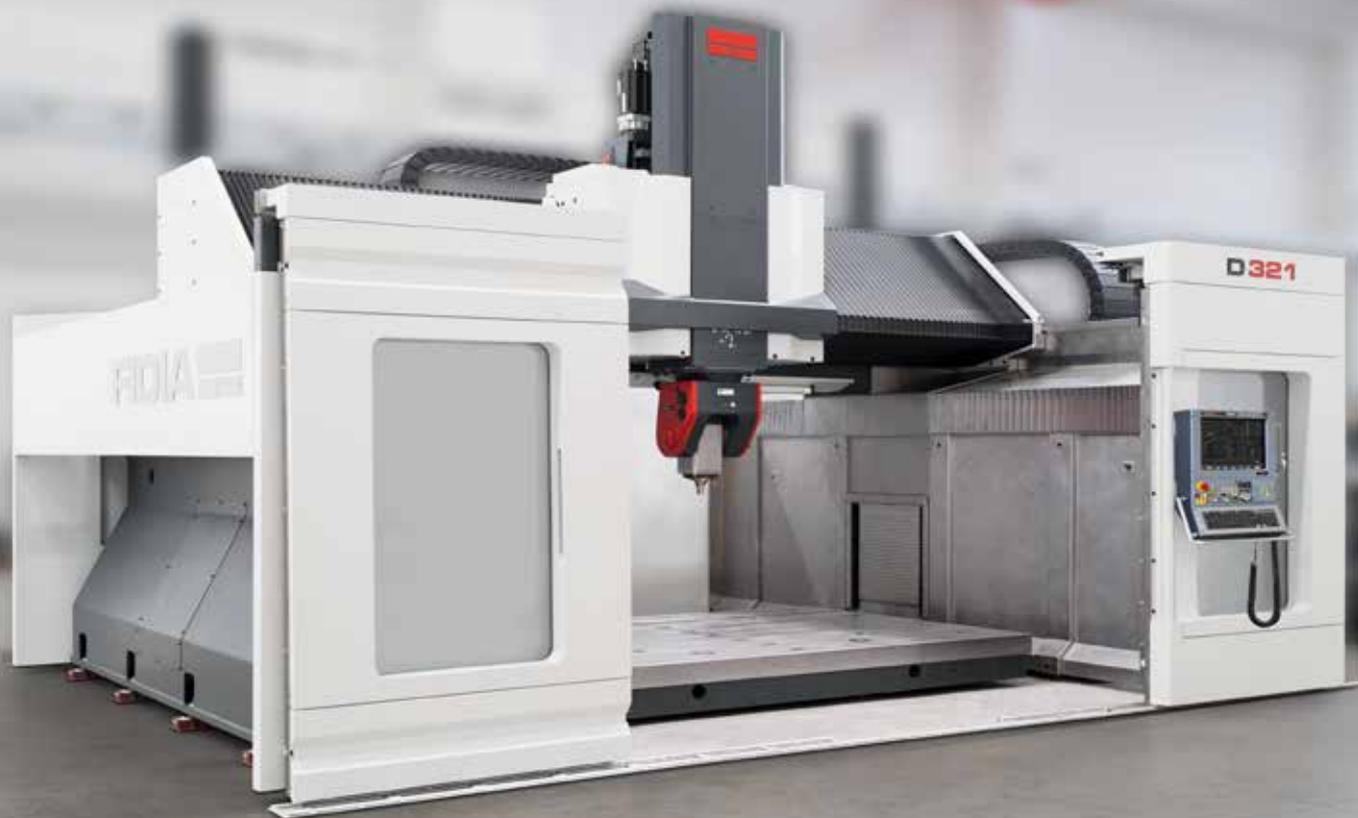
Die D321/M unterscheidet sich von der Standardversion durch eine eigensteife Konstruktion, welche auf eine Grundplatte aus Grauguss basiert, in die der Arbeitstisch integriert ist und welche die Seitenständer trägt. Diese Konfiguration ermöglicht eine leichte Fundamentplatte.
