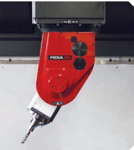
La tête M5A optimise les performances de fraisage à grande vitesse et couvre un large éventail d'applications. Dotée d'une structure en fonte garantissant robustesse et stabilité thermique, elle convient particulièrement à l'usinage de l'acier, de la fonte et de l'aluminium.
