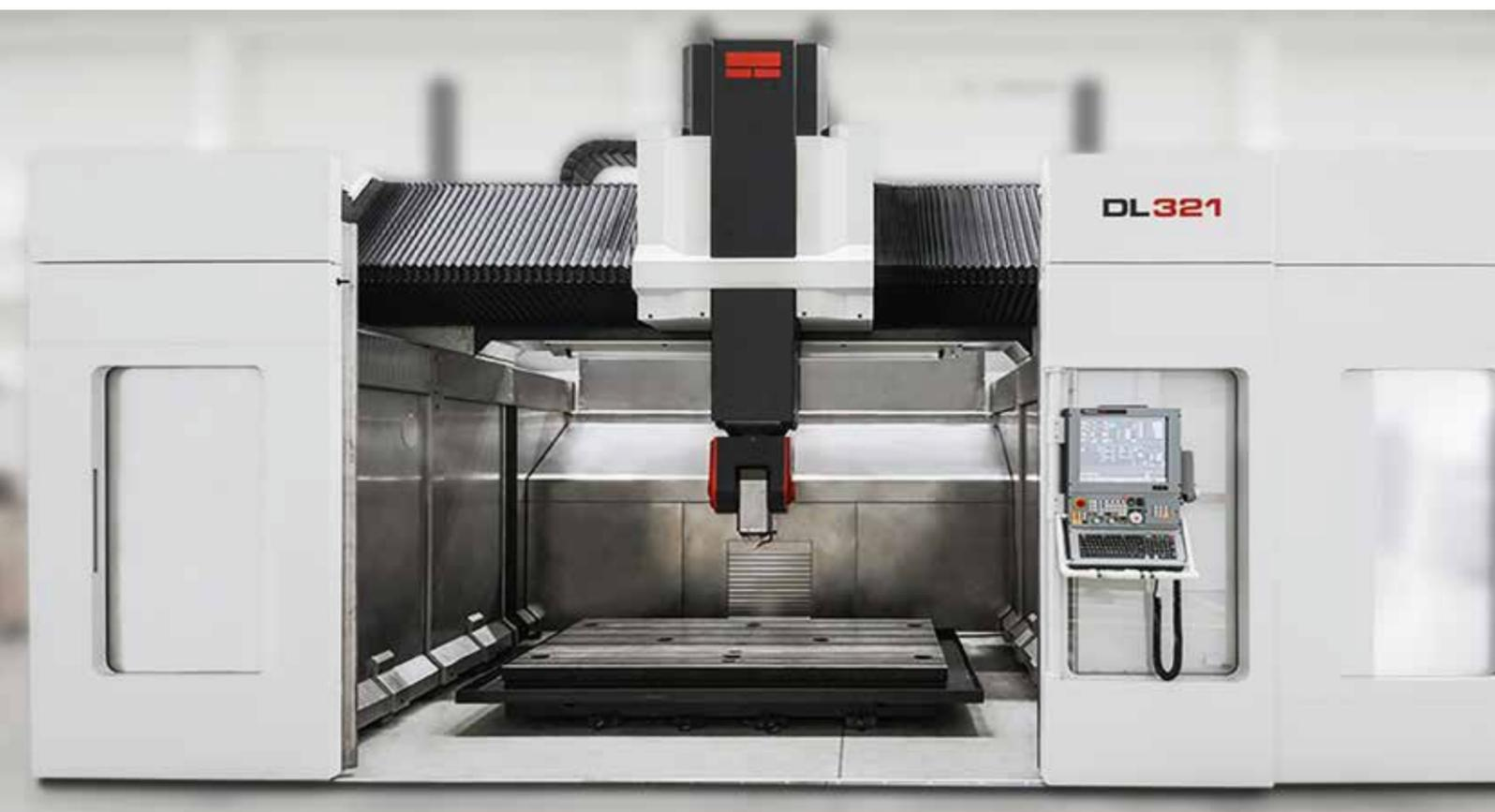
Pour les applications qui nécessitent des vitesses de déplacement rapides, sur la DL321 les vis à billes des axes X et Y à recirculation sont remplacées par des moteurs linéaires offrant des vitesses de 60 m/min.
