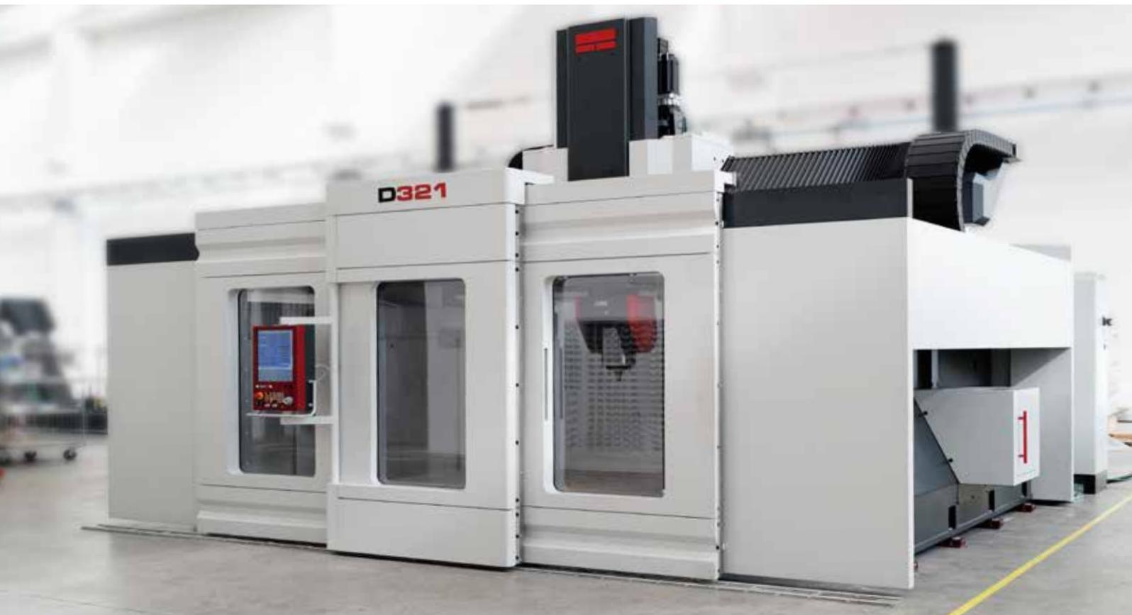
D321/M se distingue de sa version de base par une structure monolithique autoportante en fonte qui intègre dans un seul bloc, la table et les parois latérales supportant les guides de la traverse mobile.
