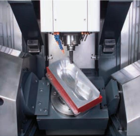
Die Maschinenreihe der HS664 umfasst Bearbeitungszentren mit 3, 4 und 5 Achsen und Verfahrwegen von X = 600 mm, Y = 560 mm und Z = 400 mm.
