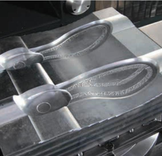
Die Fräszentren der Reihe HS664 verwenden unter anderem zwei Frässpindeln, die eigens für die gestiegenen Anforderungen des Marktes entwickelt wurden: Eine leistungsfähige Spindel mit einer Drehzahl von 24.000 1/min und einer Werkzeugaufnahme vom Typ HSK63 sowie eine extrem schnelle Spindel mit einer Drehzahl von 36.000 1/min und einer Werkzeugaufnahme vom Typ HSK50.
