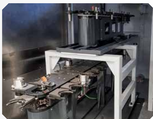
Troca de ferramentas com duplo magazine
