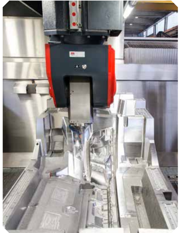
Usinagem de um estampo para a indústria automobilística
