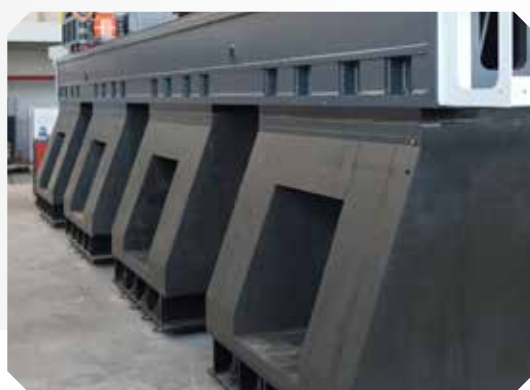
Colunas em cimento epóxi
