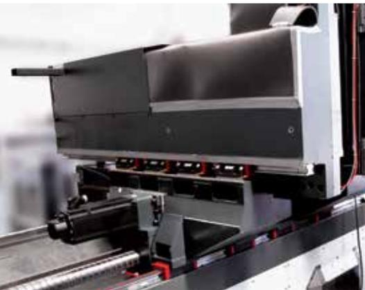
Le generose dimensioni delle guide e l'elevato numero di pattini conferiscono rigidità e smorzamento al sistema, mentre la tecnologia digitale utilizzata per gli azionamenti degli assi ottimizza il comportamento dinamico della macchina, la risoluzione e la precisione della lavorazione.
