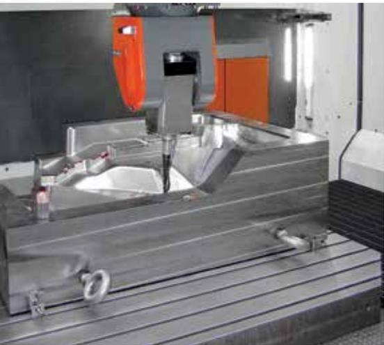
La lavorazione di stampi e componenti di dimensioni medio-grandi sono efficacemente realizzate dalla configurazione KR.
