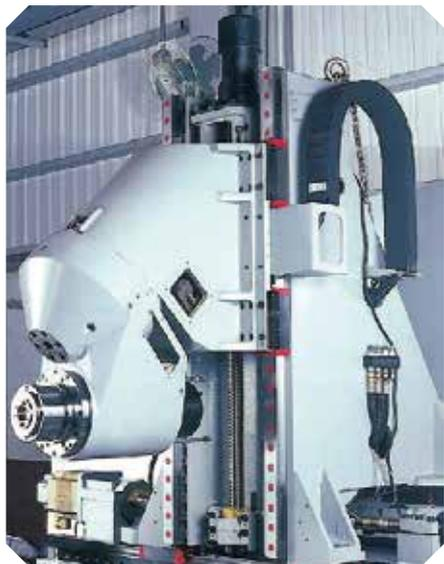
*Robuste guide con pattini a rulli specifici per le lavorazioni "heavy-duty"*
